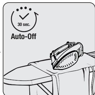
Ak so spotrebičom nepohybujete v priebehu 30 sekúnd vo bočnej polohe (doprava alebo doľava), automaticky by sa mal vypnúť.
