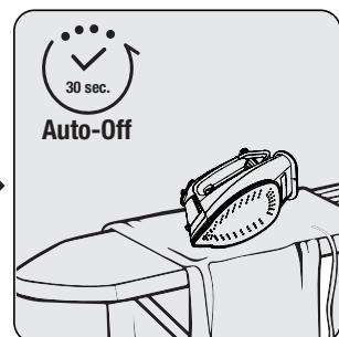
Pokud se spotřebičem nepohybujete během 30 sekund v boční poloze (doprava nebo doleva), automaticky by se měl vypnout.
