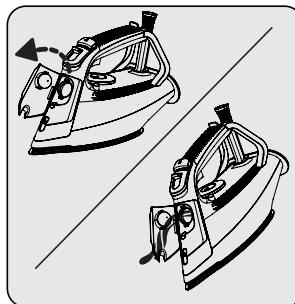
Otevřete uzávěr pro plnění vody (2) a vypustěte zbytkovou vodu ze zásobníku na vodu (8) nakloněním spotřebiče směrem dopředu.
