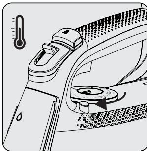
Nastavte ovladač nastavení teploty (6) do polohy „MAX“ a počkejte, dokud nezhásne indikátor termostatu (10).
