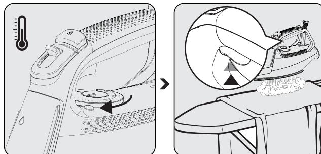
Nastavte příslušné nastavení teploty pomocí ovladače nastavení teploty (6).
