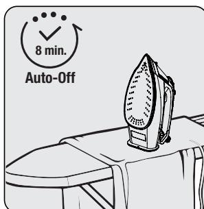
Pokud se spotřebičem nepohybujete ve svislé poloze 8 minut, automaticky by se měl vypnout.
