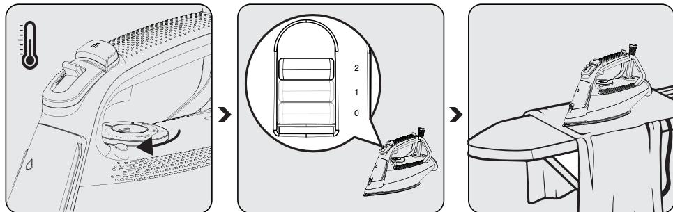
Nastavte príslušné nastavenie teploty pomocou ovládača nastavenia teploty (6).
