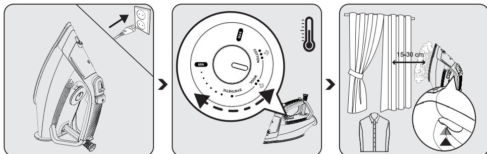
Naplňte zásobník na vodu (8) vodou (pozrite si 3.3). Postavte spotrebič do vzpriamenej polohy a zapojte ho do elektrickej zásuvky.
