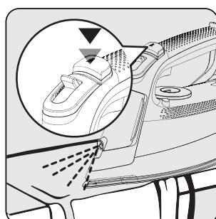
Stiskněte tlačítko kropení vodou (4) a pokračujte v žehlení.
