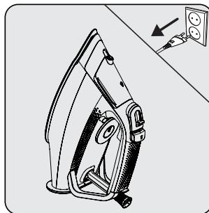
Pred čistením odpojte spotrebič z elektrickej zásuvky.
