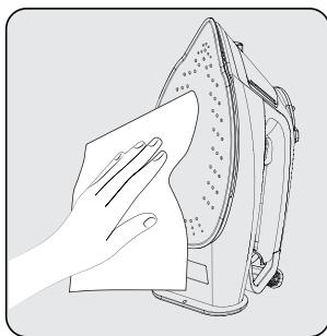
Zbytky mimo spotřebič a na žehlicí ploše (9) otřete vlhkým hadříkem a případně lehkým neabrazivním tekutým čisticím prostředkem.
