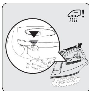
Položte spotrebič vodorovne na umývadlo a žehličkou zatrasťte so súčasným stlačením tlačidla na odstránenie vodného kameňa „“ (7). Pokračujte, pokiaľ voda v zásobníku na vodu (8) nevytečie. Po dokončení uvoľnite tlačidlo (7).
