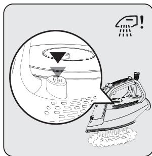
Položte spotřebič vodorovně na umyvadlo a žehličkou zatřeste se současným stisknutím tlačítka na odstranění vodního kamene
