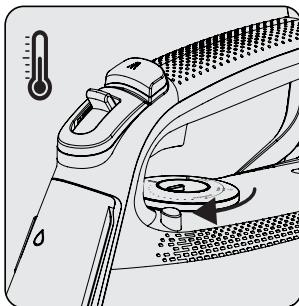
Nastavte ovládač nastavenia teploty (6) do polohy „MAX“ a počkajte, pokiaľ nezhasne indikátor termostatu (10).
