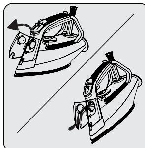
Otvorte uzáver na plnenie vody (2) a vypustite zvyškovú vodu zo zásobníka na vodu (8) naklonením spotrebiča smerom dopredu.
